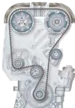
O acionamento de correia em automóveis têm duas funções: o controle das válvulas é assumido por uma correia dentada, que transmite o movimento rotativo do virabrequim, por ligação positiva, para o eixo de comando de válvulas na relação 2:1, proporcionando assim a interação temporalmente sintonizada entre si (tempos de controle) entre o movimento do êmbolo e o controle da válvula.
