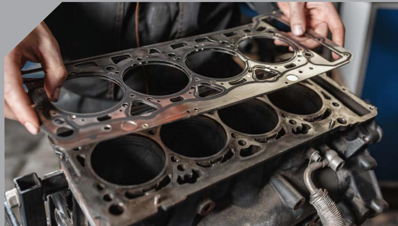
A principal função de qualquer junta é efetuar uma perfeita vedação entre a junção de duas peças metálicas, para que não ocorram vazamentos. Além de garantir o estancamento entre o bloco do motor e o cabeçote, a peça suporta altas pressões e temperaturas geradas na parte interna do motor.
