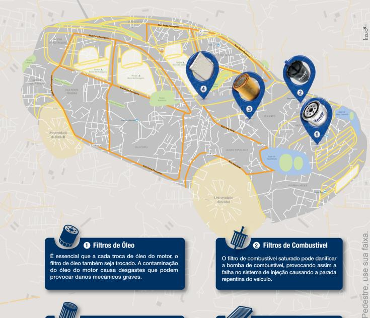
É essencial que a cada troca de óleo do motor, o filtro de óleo também seja trocado. A contaminação do óleo do motor causa desgastes que podem provocar danos mecânicos graves.
