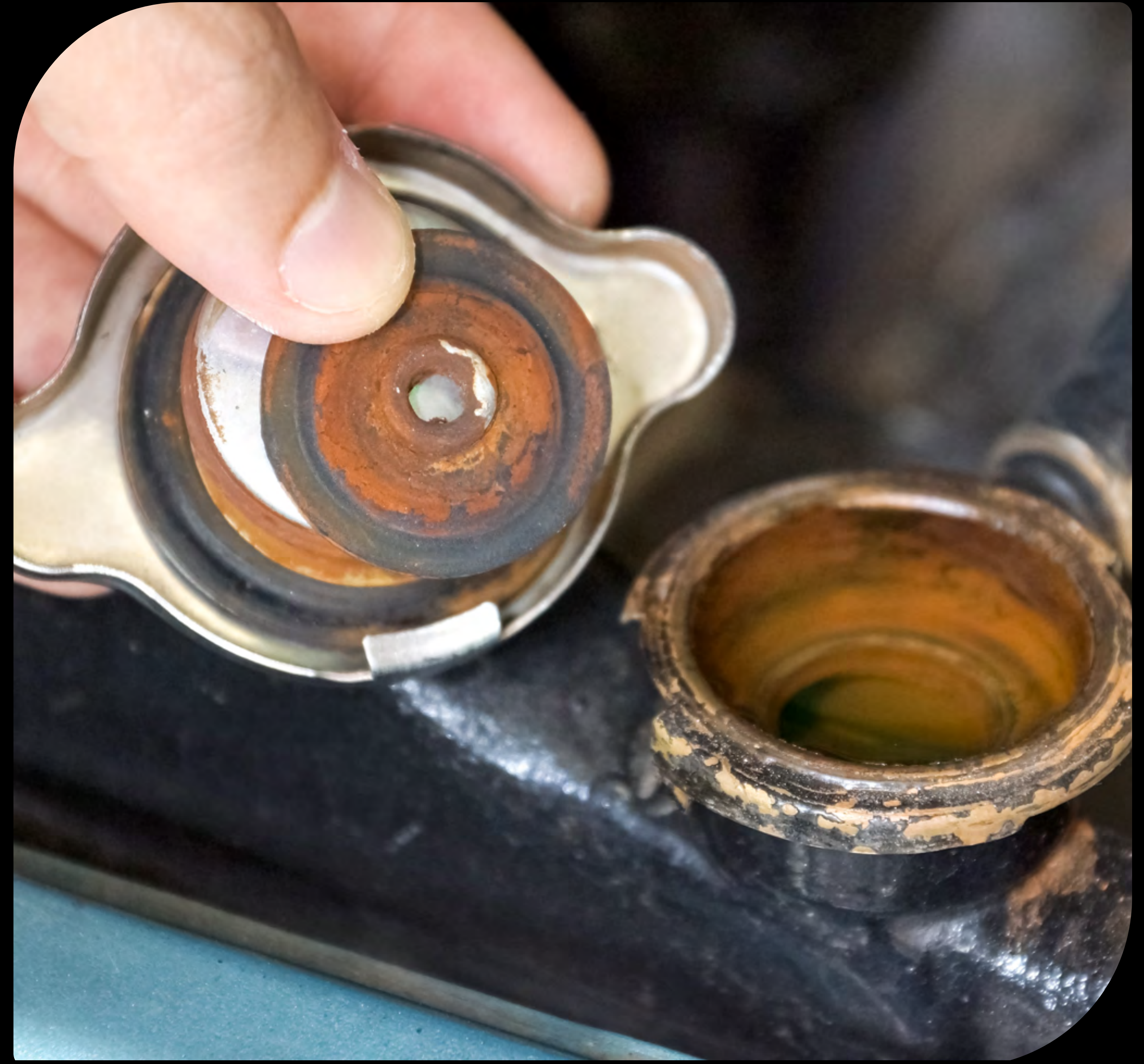
Oxidação do radiador por contaminação de água potável
