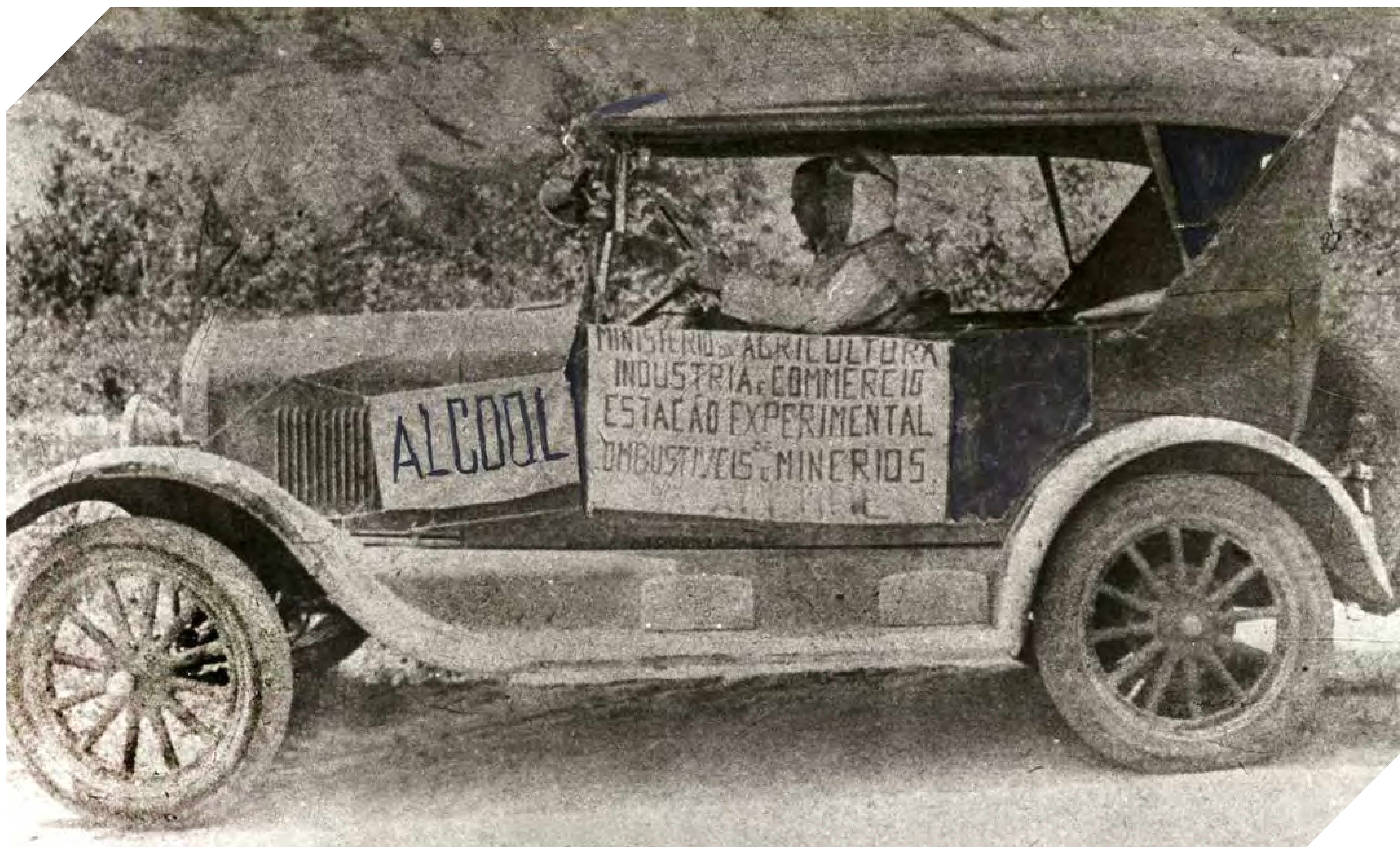
Automóvel adaptado para funcionar com álcool etílico hidratado, em 1925
