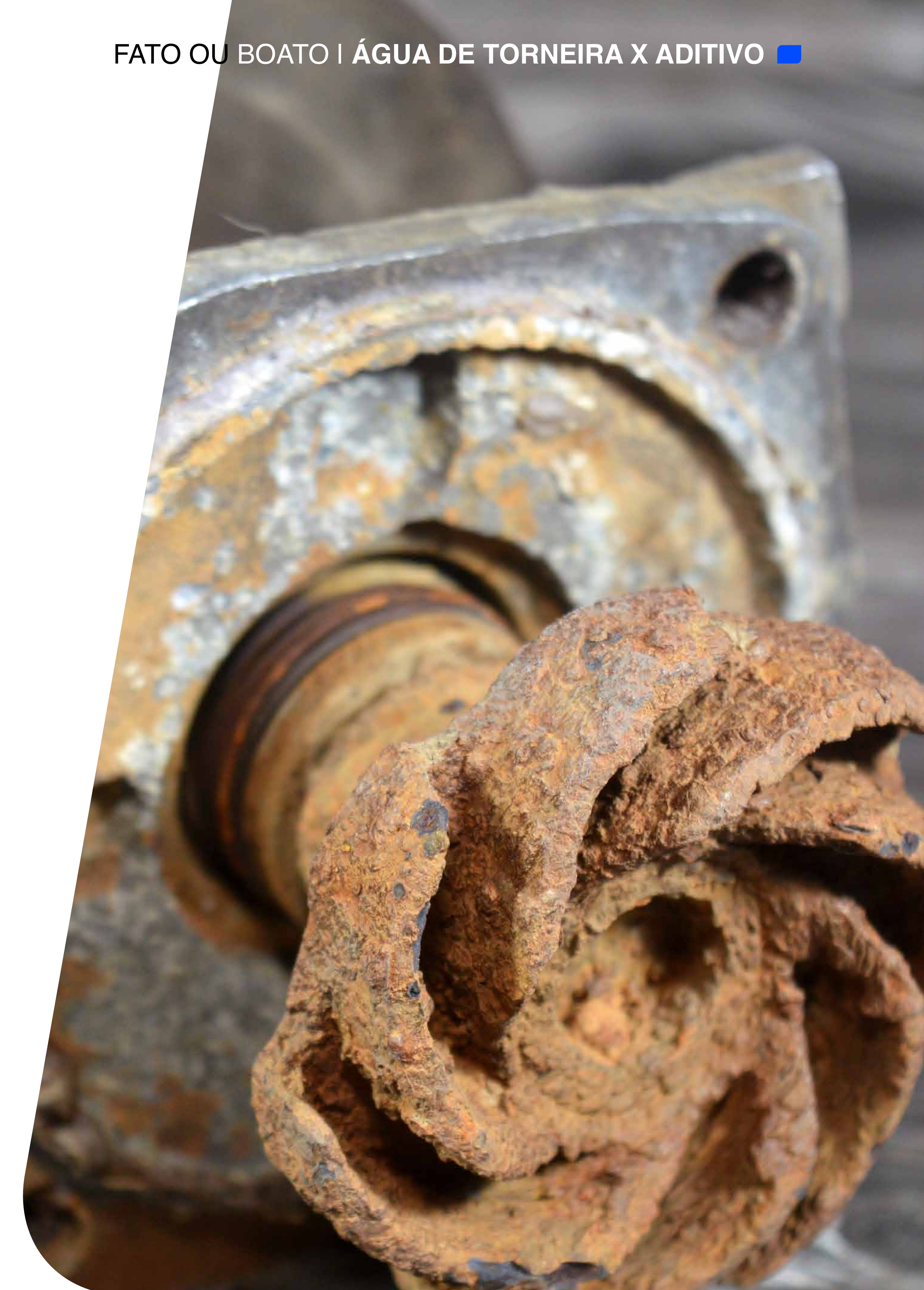
Bomba d'água danificada pela ferrugem por falta do líquido correto no sistema de arrefecimento
